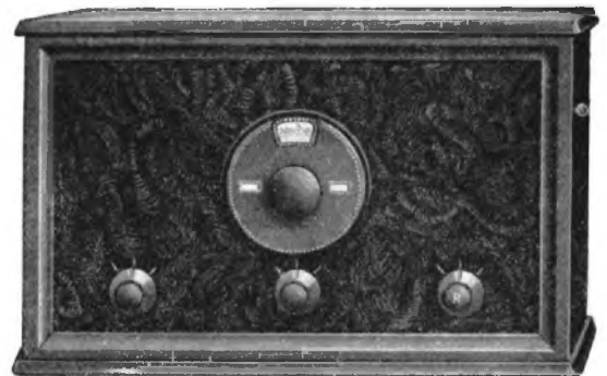
Figuur 1. Vooraanzicht van den Seibt 4-lamps neutrodyne, type E. I. 445.
